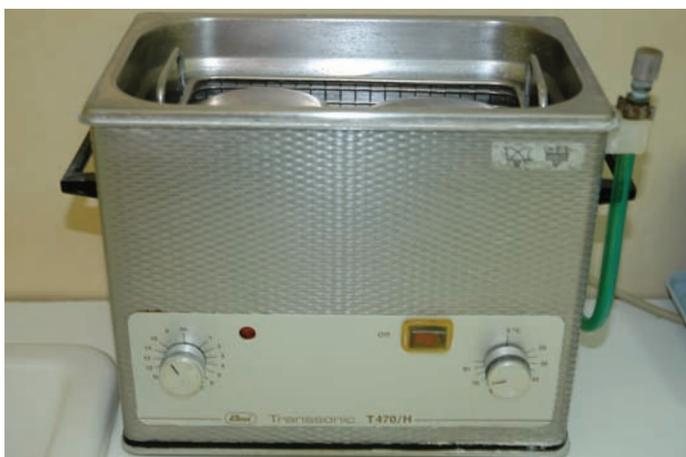
Vasca ad ultrasuoni per detersione strumenti
